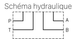
Embase simple avec orifices A-B latéraux, P-T latéraux et arrière avec limiteur de pression. Poids = 3 Kg
