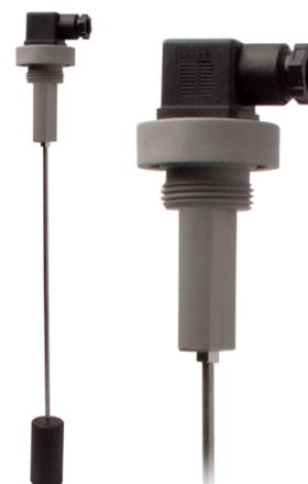
Les détecteurs de niveau capacitifs de type S45 et S46 sont des appareils électroniques qui contrôlent la présence d'huile, de carburant ou d'eau dans un réservoir. Les modèles S45 et S46 sont conçus sans pièces en mouvement et ils établissent un contact après 10 secondes passées hors liquide. Ils remplacent donc avantageusement les détecteurs mécaniques qui peuvent se déclencher par les vibrations ou les turbulences de liquides.
