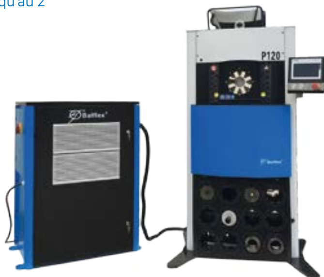
Presse électrique de sertissage pour tuyaux 2" - 6 Nappes et 4" Industriel
